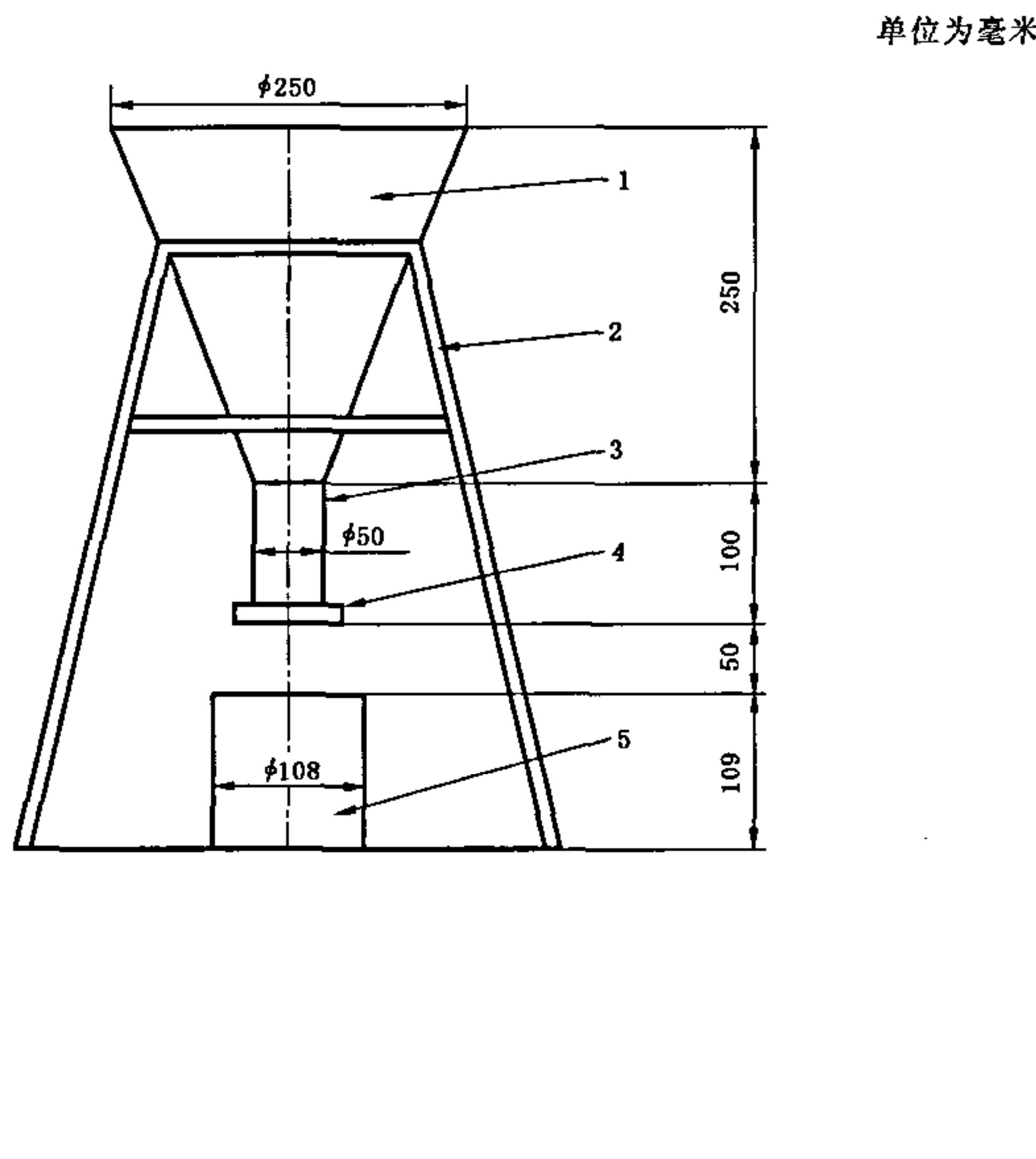
图 A.1 堆积密度试验装置
